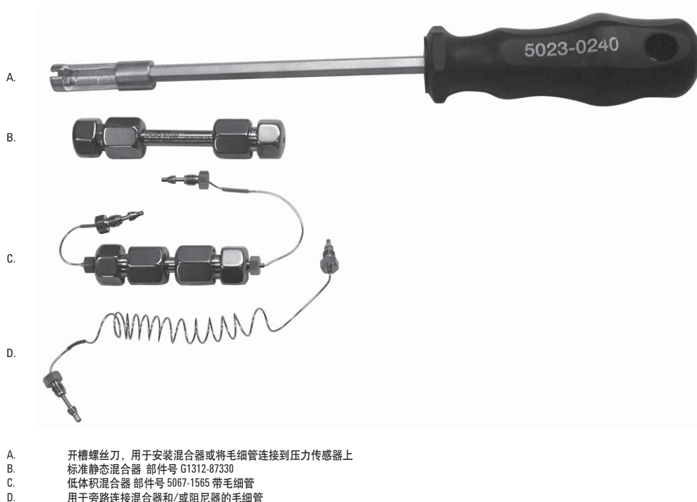
图 6. 延迟体积可以用各种混合器和毛细管调节
