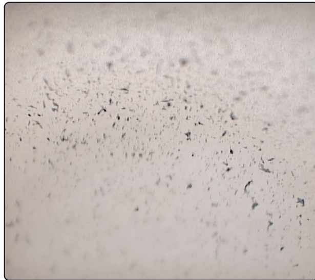
圖3. 在裝有蛋白質變性液之蓋中的雷射顯微切割與壓力彈射 (LMPC) 均質化切片
