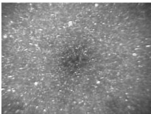
图4. 激光剥蚀之前BaTiO 3 片的CCD图像
