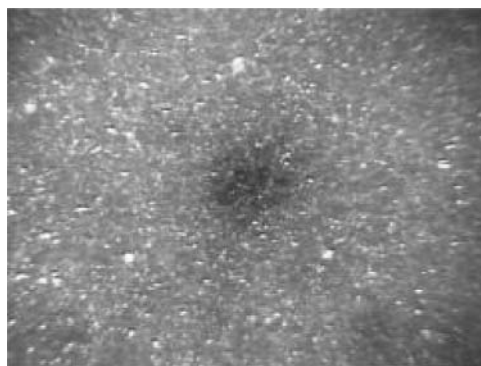
图5. 激光剥蚀后BaTiO 3 片的CCD图像显示样品损伤近乎其微(激光直径10 μm)
