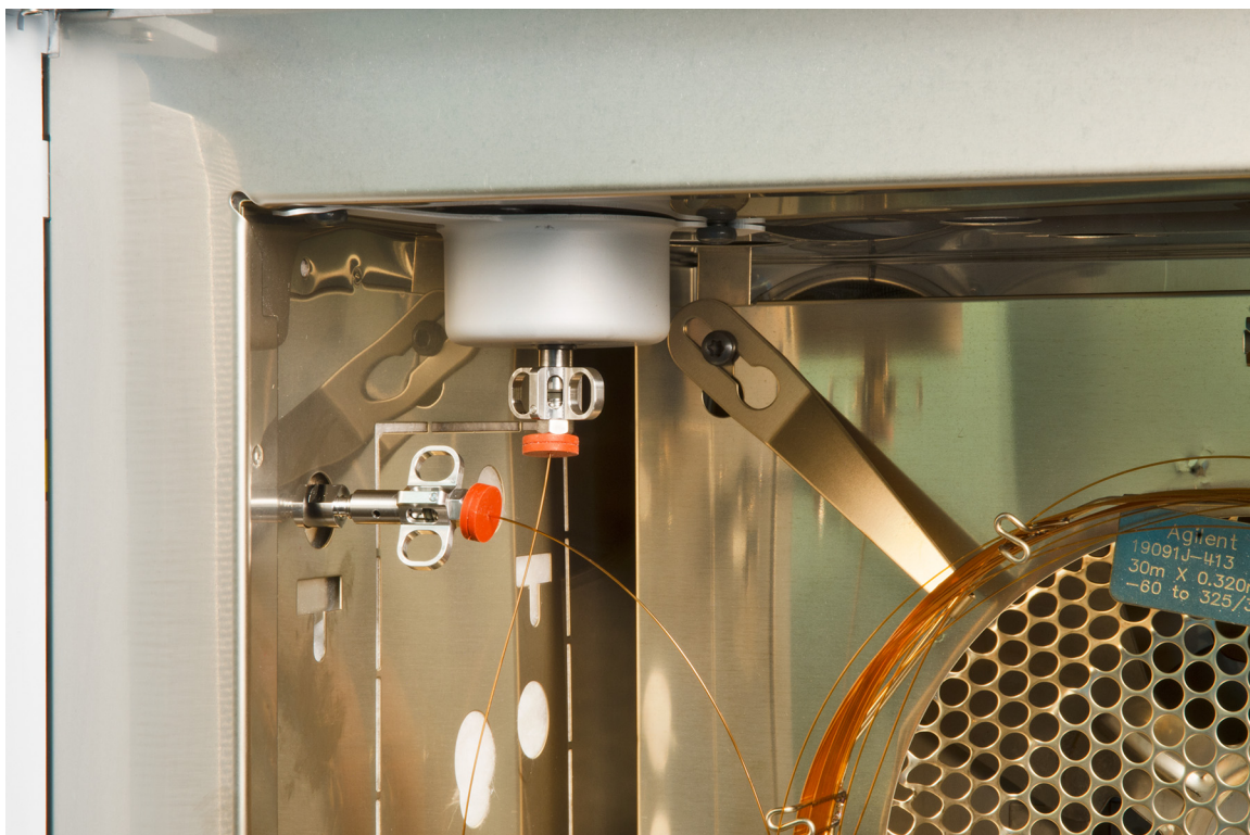
Figura 6 Instalación de una columna capilar en la interfase de GC/MS
