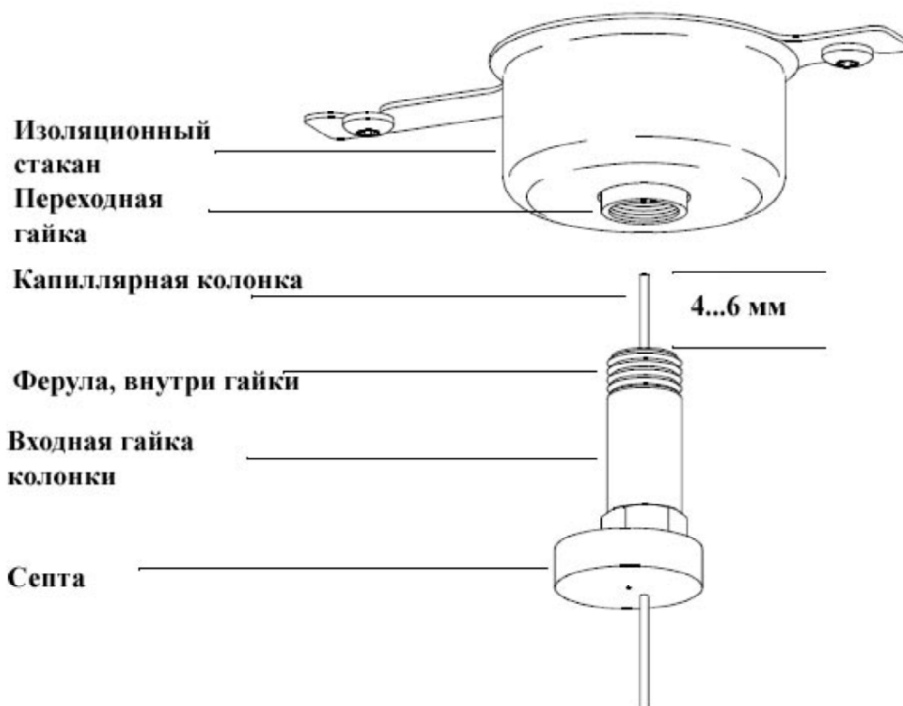
Рисунок 8 Установка капиллярной колонки в инжектор с разделением/без разделения потока
