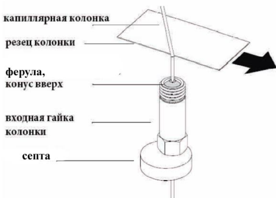
Рисунок 7 Подготовка колонки к установке
