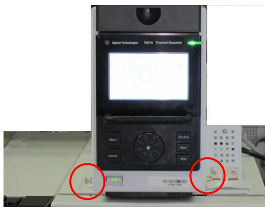
Figura 22 Posições dos parafusos fixos na Mini TD
