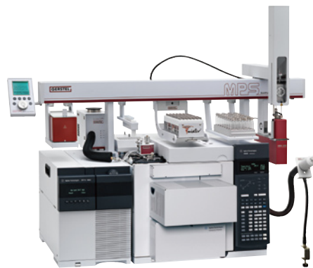
▲ GERSTEL 1D/2D 切替 GC-MS におい分析システム
