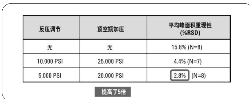
图 6 反压调节——在出口减少大气压波动的影响。随大气压变化，加载气体进样阀会产生波动
