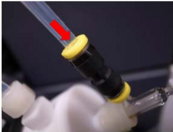
キャリアガスラインをコネクタに押し込む (ガラス製ネブライザの場合)
