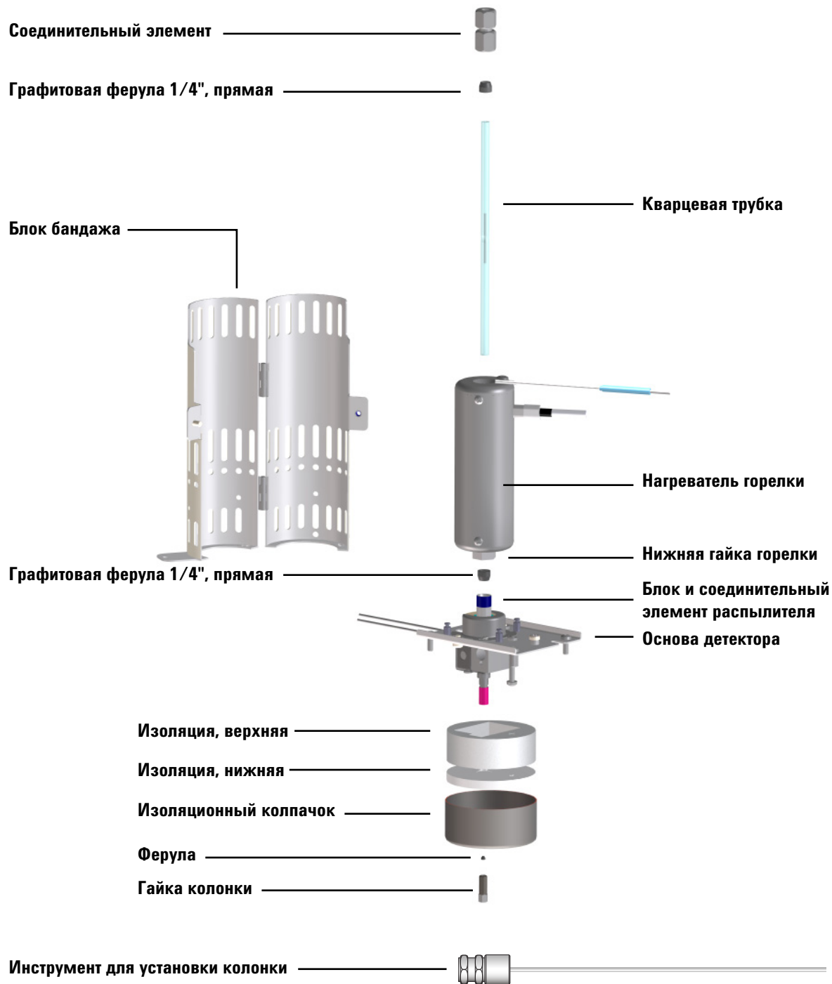
Рис. 9 ХДА в разобранном виде
