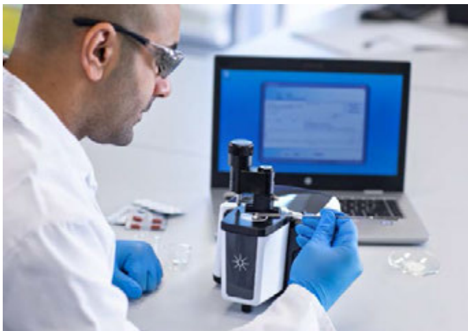
Рисунок 1. ИК-Фурье-спектрометр Agilent Cary 630 может быть оснащен модулями отбора проб, подходящими для решения всех аналитических задач. Приставки НПВО с алмазным кристаллом для модуля отбора проб идеально подходят для инфракрасной спектроскопии с Фурье-преобразованием твердых проб, жидкостей, гелей и порошков методом ИК-Фурье-спектроскопии.
