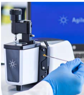
Рисунок 8. Спектры концентратов и дистиллятов каннабиса регистрировались без какой-либо подготовки пробы с помощью ИК-Фурье-спектрометра Agilent Cary 630 с модулем НПВО с алмазным кристаллом.
