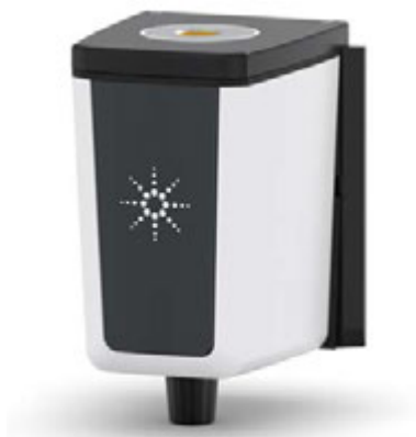
Рисунок 5. Приставка для работы в режиме НПВО с многократным отражением с кристаллом из селенида цинка для ИК-Фурье-спектрометра Agilent Cary 630.
