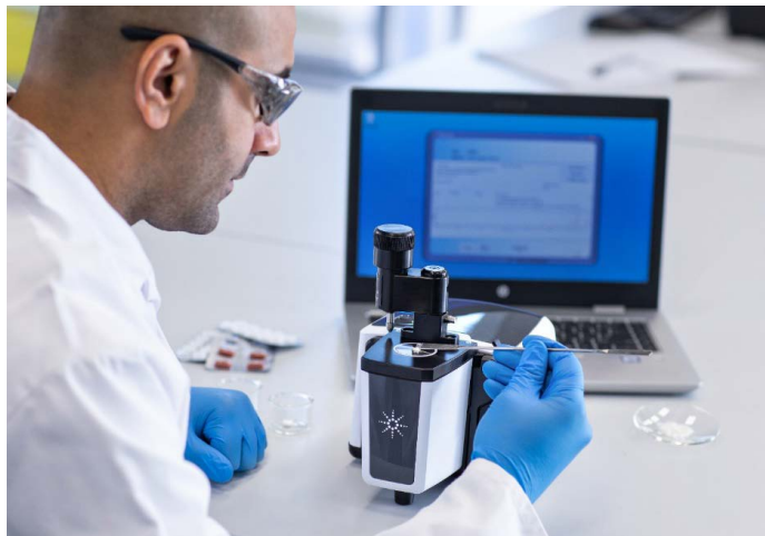
图 1. Agilent Cary 630 FTIR 光谱仪可配备适当的采样附件，以满足所有分析需求。钻石晶体 ATR 采样附件是固体、液体、糊状物和凝胶 FTIR 分析的理想选择
