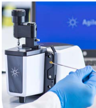
图 8. 使用配备钻石 ATR 附件的 Agilent Cary 630 FTIR 光谱仪，无需任何样品前处理即可记录大麻浓缩物和馏分油的光谱
