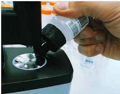
图 9. 将洗手液样品置于 Agilent Cary 630 FTIR 的 ATR 附件上。Angilen MicroLab 软件通过图片引导式工作流程，帮助用户进行清洁和采样在内的每个测量步骤。
