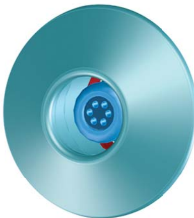
Figura 4. Conjunto de amostragem de capilar de seis furos e placa de orifícios. O capilar de seis furos espalha a zona de confinamento térmico do AJS permitindo uma amostragem de íons muito maior.
