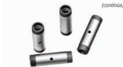
Tubo de grafito, pirorrecubierto, HGA (ref. 0800-0962)
