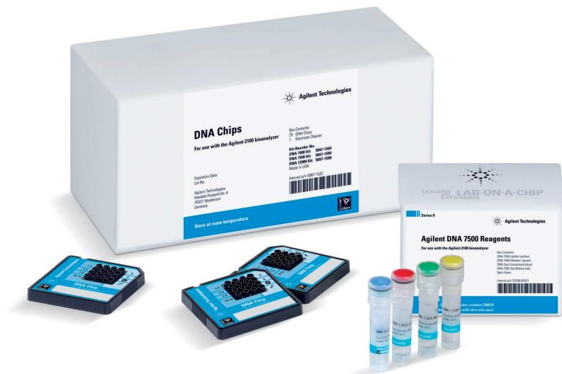
安捷伦 DNA 试剂盒与 Agilent 2100 生物分析仪系统结合，适用于 PCR 片段、限制性酶切片段或片段化 DNA 的自动化分子量测定与定量分析。
