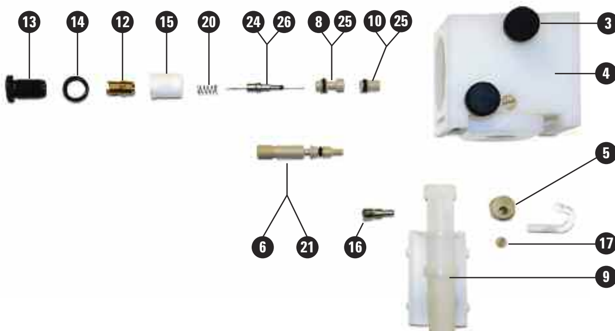
Vista explodida do bloco nebulizador a partir da câmara de nebulização Mark 7
