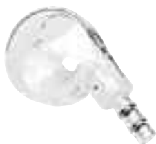
Câmara de nebulização ciclônica tipo passo único, 2010081700
