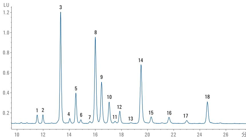
2.7  $\mu$ m AdvanceBio Glycan マッピングカラムにより、低い背圧で高速な分析結果が得られました。2.7  $\mu$ m AdvanceBio Glycan マッピング充填剤はアジレントの表面多孔質粒子を使用して低いカラム背圧で高い性能を実現しています。カラム長が 100 mm および 150 mm の場合、一般的なカラム圧は 2-AB ラベル化糖鎖の推定分析メソッドでは 400 bar 未満となります。
