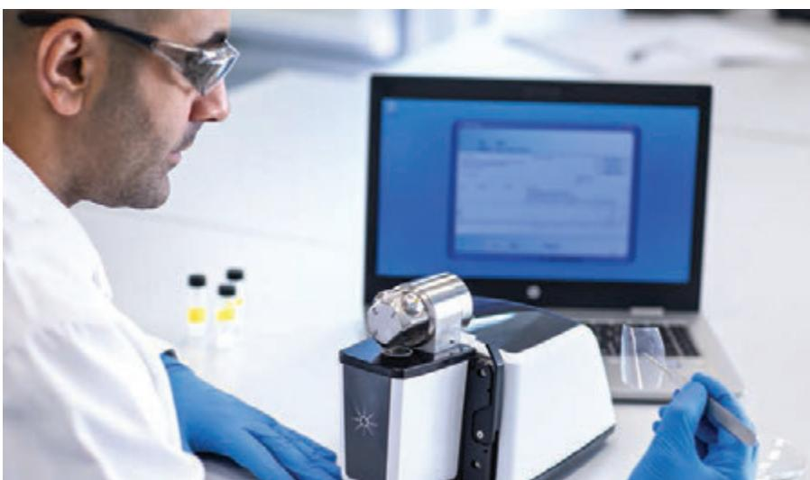
Приставка Agilent DialPath упрощает анализ контрольных пластин и пленок полимеров. Приставка DialPath – это серебристый модуль сверху прибора. Она позволяет снимать спектры пропускания с фиксированными длинами оптического пути.
