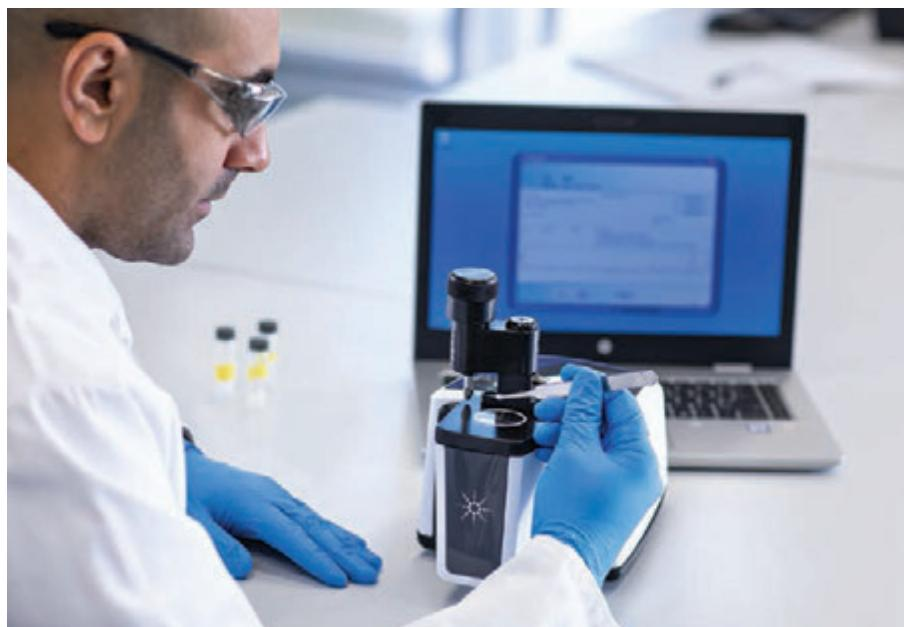
ИК-Фурье-спектрометр Agilent Cary 630 с приставкой однократного нарушенного полного внутреннего отражения (НПВО) с алмазным кристаллом. Он позволяет анализировать такие сополимеры, как БСК или этиленвинилацетат (ЭВА).
