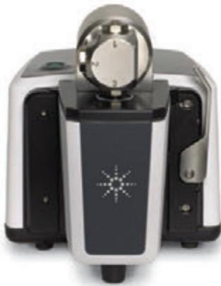
Спектр полиэтилена записывался с помощью ИК-Фурье-спектрометра Agilent Cary 630 с приставкой DialPath или TumblIR с длиной оптического пути 1000 мкм.
