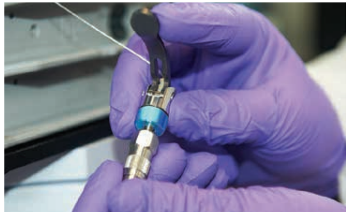
Einfach durch Betätigen eines Hebels: Das Agilent-eigene Design hat einen Federmechanismus, der für null Totvolumen und eine sichere und feste Verbindung sorgt.
