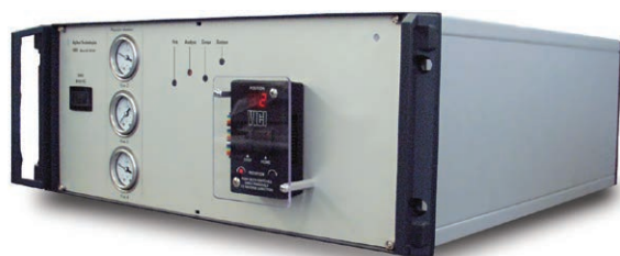
19 英寸机箱内的 Agilent 490-PRO 微型气相色谱仪
