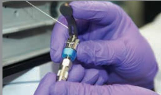
**Aussi simple que d'enclencher un levier** : le concept exclusif d'Agilent fonctionne à l'aide d'un mécanisme de ressort précontraint pour une connexion étanche sans volume mort, sécurisée.
