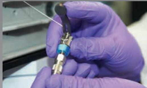
**Tan sencillo como accionar una palanca:** el diseño patentado de Agilent incorpora un mecanismo accionado por resorte sin volumen muerto y una conexión firme y segura.
