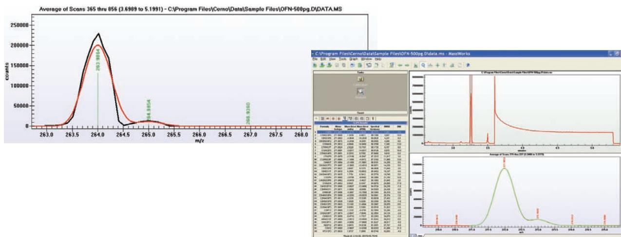
Использование калибровки по ПФТБА для пика октафторнафталина, элюировавшегося в момент времени 3,25 минуты. Точная моноизотопная масса октафторнафталина определяется в пределах 2 мДа его точной массы. Поиск компонентов CLIPS надлежащим образом определяет элементный состав с максимальной спектральной точностью 99,7% на тех участках, где теоретический (зеленый) и откалиброванный (красный) масс-спектры приближаются к уровню шума.
