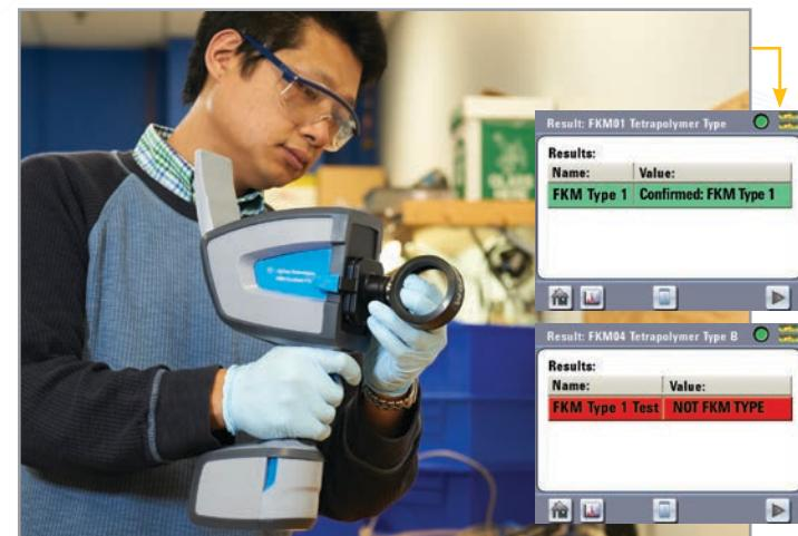
В выбранном для анализа уплотнительных колец методе MicroLab порог был установлен таким образом, что образцы в пределах целевой группы были помечены зеленым цветом, а за ее пределами – красным. Кроме того, для отображения настраиваемых предупреждающих сообщений (например, «Confirmed FKM Type 1» (Подтвержден тип FKM 1) для образцов в пределах целевой группы и «NOT FKM TYPE» (Не соответствует типу FKM 1) для образцов за ее пределами) может использоваться функция условной отчетности.
