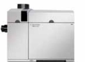
В ассортименте AAC «Аджилент» — самые быстродействующие в мире приборы с пламенным атомизатором и самые чувствительные в мире приборы с графитовым электротермическим атомизатором.
