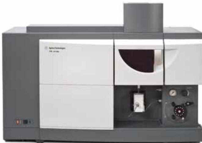
ИСП-ОЭС серии 710 фирмы «Аджилент» оснащены твердотельными детекторами на ПЗС и прекрасно подходят для лабораторий, где требуется высокая эффективность при среднем пробопотоке.
