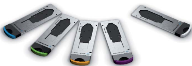
液相色谱-芯片适合广泛的应用领域。融合碳离子注入过滤器技术的第二代芯片技术改进了表面的接触和密封特性，降低了聚酰亚胺芯片和转子之间的摩擦
