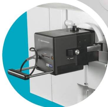
Source MALDI avec focalisation dynamique pulsée pour une sensibilité et une cohérence améliorées
