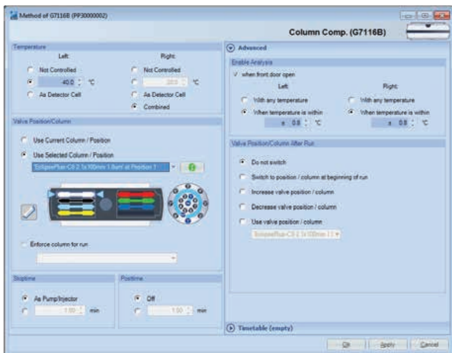
Рис. 3. Выбор колонок в ПО на экране методики термостата Agilent 1290 Infinity II МСТ
