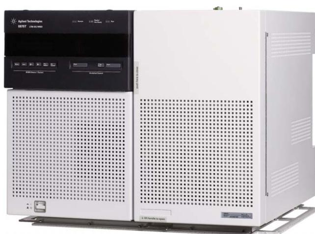
图 1. Agilent 5975T LTM GC/MSD 的照片
